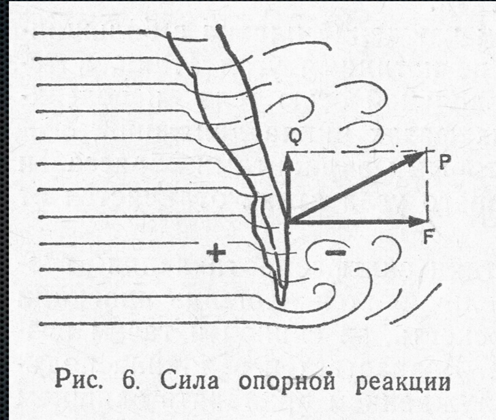
Рис. 6. Сила опорной реакции
